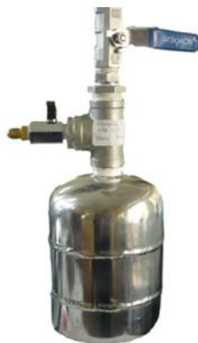
Gambar 2. Bejana logam untuk perendaman sampel dengan gas DME
