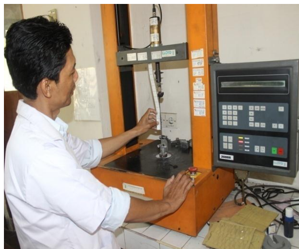
Gambar 3. Uji kuat tarik menggunakan alat tensometer LLYOD
