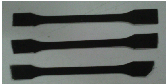
Gambar 1. Sampel dengan ISO 527-2-1A
