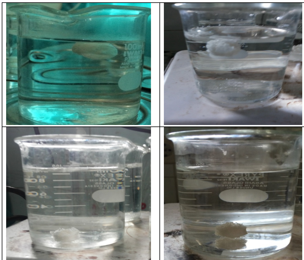
Gambar 2. Uji keterapungan formula kontrol (A), formula 1 (B), formula 2 (C) dan formula 3 (D)
