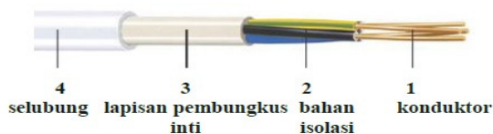
Gambar 1. Konstruksi kabel NYM [10]
